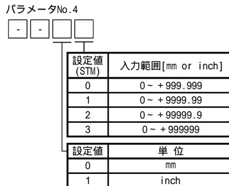
正転始動 (ST1) または逆転始動 (ST2) をONすると設定した位置へサーボモータが回転します。速度ブロックの選択は前記の絶対指令と同一です。また,サーボモータの回転方向は本項(1)と同様,パラメータNo.2により決まります。
