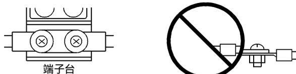
(c) サーボモータ側の電源用コネクタは、EN規格対応品を使用してください。当社ではオプション品としてEN規格対応電源コネクタセットを用意しています。(15.1.6項参照)
