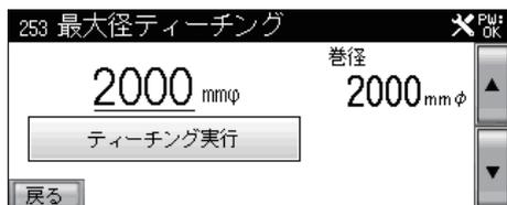
5. タッチレバーを最大径の位置にするか超音波センサに対して最大径の巻枠を対向させます。
