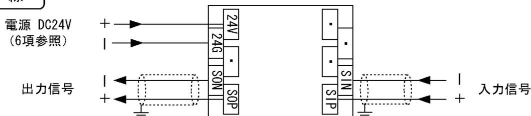
※入/出力信号の配線はシールド線を用い、入力側はコンバータ近傍、出力側は相手方装置の近傍で確実にアースを取ってください。また、他の動力線と同一ダクトに通したり一緒に結束しないでください。
